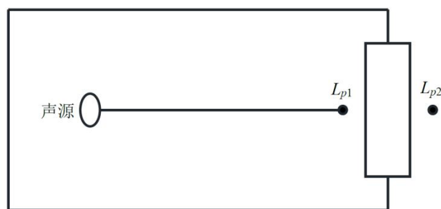
图 6.3-1 室内声源等效为室外声源图例
